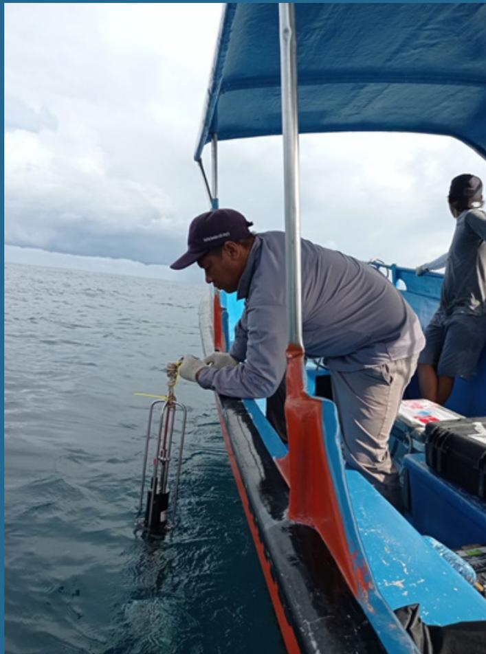
Gambar 4. Pengambilan parameter suhu, salinitas dan kedalaman menggunakan CTD
