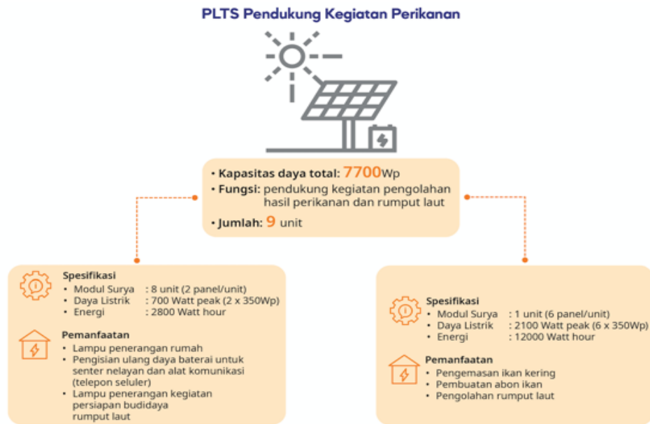
Gambar 7. Pembangkit listrik tenaga surya (PLTS)
